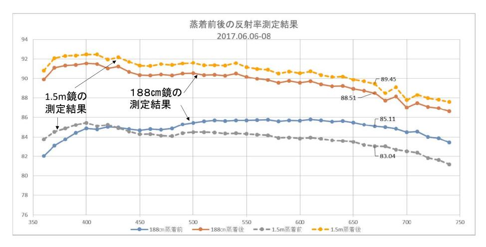
図1. 2017年6月の蒸着前後の反射率測定結果 同時期に蒸着作業を行った東広島天文台1.5m鏡の反射率測定結果も掲載している。 ラベルの数字は 波長670nm での数値を示している。
