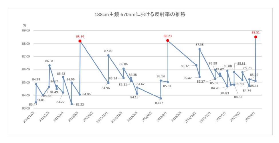
図2. 188cm主鏡670nmにおける反射率の推移 赤いマーカーとラベルは、蒸着後の反射率を示している。
