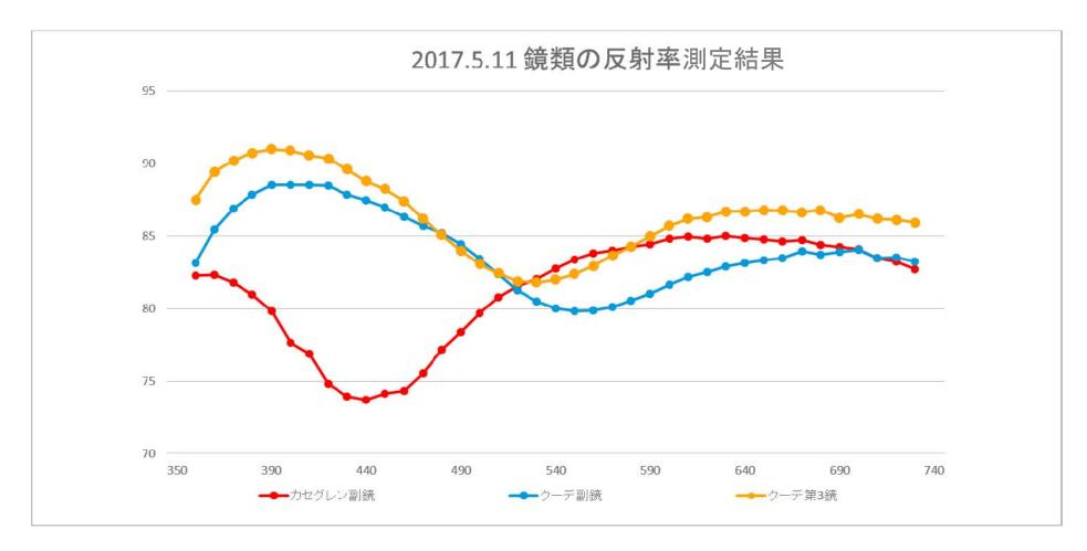
図3. 2017年5月11日測定のカセグレン副鏡、クーデ副鏡、クーデ第3鏡の反射率測定結果
