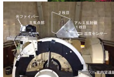
図1. 分光専用金属鏡望遠鏡(2014秋)。アルミ製の反射鏡で集められた光は焦点部の光ファイバーを通して1階に導かれ、低分散分光装置で観測される。
