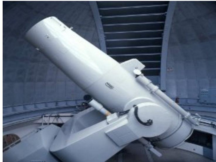
木曽105cmシュミット望遠鏡(使用filter : SDSS u,g and i)
