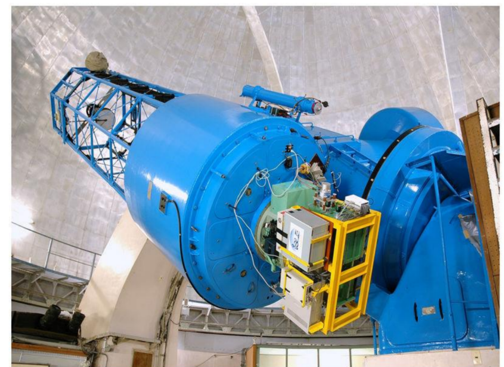
【188 cm 望遠鏡のカセグレン焦点に取り付けられた ISLE】
