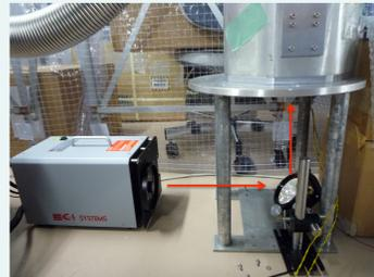
Fig.4: 黒体炉とデュワーの配置
