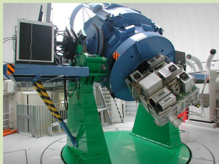
広島大学かなた望遠鏡1.5m B, V, Rc, Ic, z, J, H 測光 可視分光
