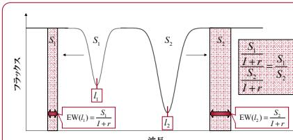
Fig 3. 近接する吸収線の等価幅比を算出することで、ベーリング量 $r$ に依らない量を算出できる。離れた吸収線を用いた場合、ベーリングの波長依存性を考慮しなくてはならないため、導出が困難になる(Doppmann et al. 2005)。
