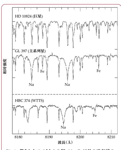
Fig 4. 得られたスペクトルの例。Na, Fe以外の吸収線のほとんどが、地球大気の吸収線である。
