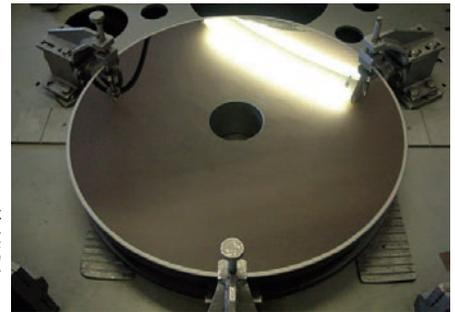
図 4-17 岡山天体物理観測所で再蒸着された 60cm 望遠鏡の主鏡
