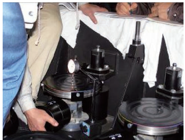
図 4-15 主鏡アキシタルサポートおよび同固定点の改修
