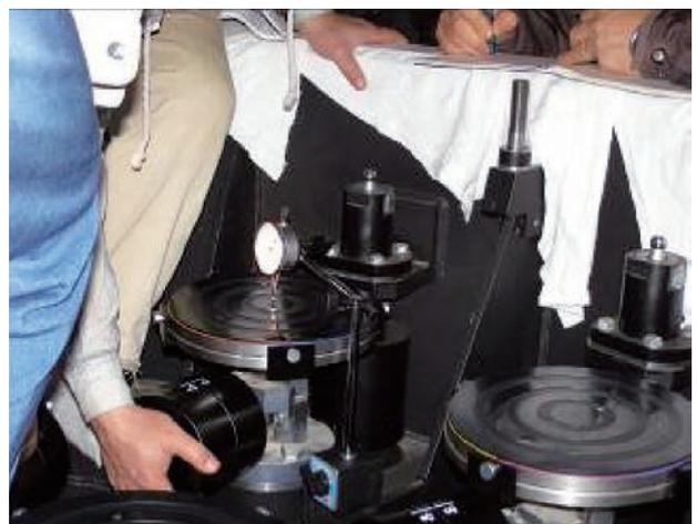
図 4-15 主鏡アキシャルサポートおよび同固定点の改修
