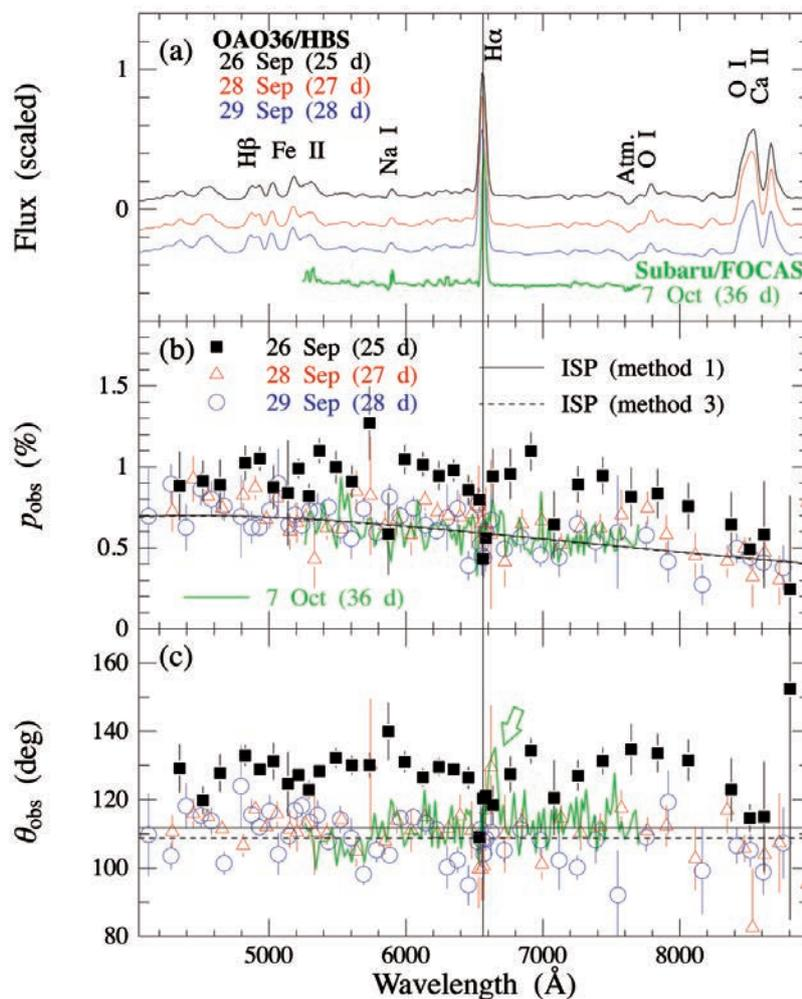
図1 V475 Sct (Nova Sct 2003) の (a) フラックス、(b) 偏光度、(c) 偏光方位角の波長依存性。9月25日(極大光度から25日目)から29日までの観測が岡山91cm鏡での、10月7日(同36日目)の観測がすばるでの観測データ。(b)(c)の黒曲線は星間偏光成分。25日目に連続光が示した偏光と同じ方位角の偏光を、36日目のH $\alpha$ 輝線の赤側ウィング部で捕えている(矢印で示してある)。
