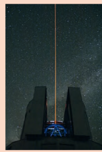
補償光学装置に必要な人工ガイド星作るためのレーザー照射。
