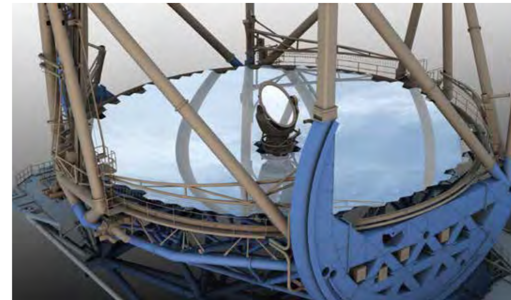
492枚の分割鏡からなる、口径30mの主鏡 対角1.44mの分割鏡を、2.5mmのすき間で敷き詰めています。
