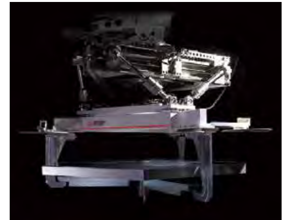
分割鏡交換ロボットの試作品。TMT の主鏡の反射率を最高の状態に維持するため、一日に 10 枚もの分割鏡を再メッキした予備の分割鏡と交換する必要があります。すばやく正確に、安全に鏡を交換するため、分割鏡交換ロボットが、望遠鏡本体構造の付帯設備として考案されました。(画像 © 三菱電機株式会社)
