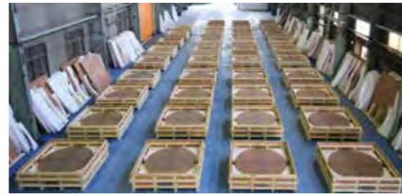
量産が進んでいる主鏡用鏡材。夜間の温度変化によって鏡が伸び縮みしないよう、鏡の材料には、熱膨張率ゼロの特殊なガラスセラミックスを用います。国外で研磨する分については、球面研削を終えた段階で、米国、中国、インドへ輸送されます。(画像 © NAOJ/OHARA)
