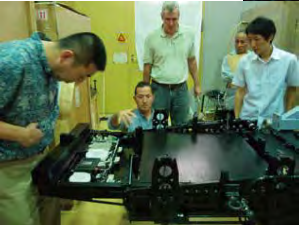
国際協力で製作された HSC フィルター交換機構の受け入れ審査
