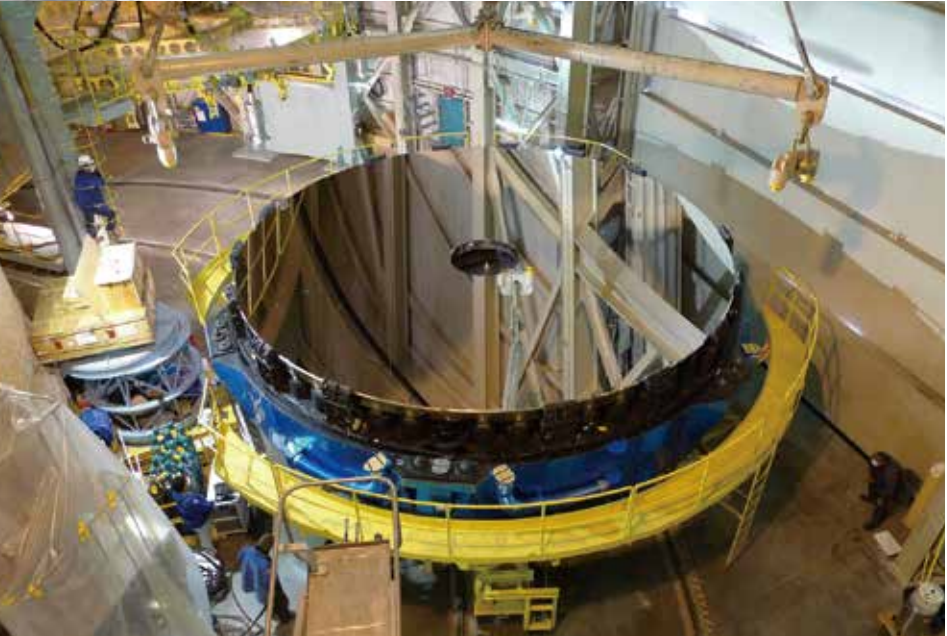
アルミニウム蒸着を終え，望遠鏡に搭載される直前の主鏡。直径 8 m 級の 1 枚鏡を主反射鏡として用いるためには，能動光学とよばれる技術が必要となります。重さを最小限にするため，すばるの鏡の厚さは 20 cm しかありません。このままでは望遠鏡を傾けると歪んでしまい，形を保持できないのですが，261 本ものアクチュエーターとよばれるロボットの指が主鏡を支え，望遠鏡がどの方向を向いても，つねに鏡を理想的な形に保ちます。
