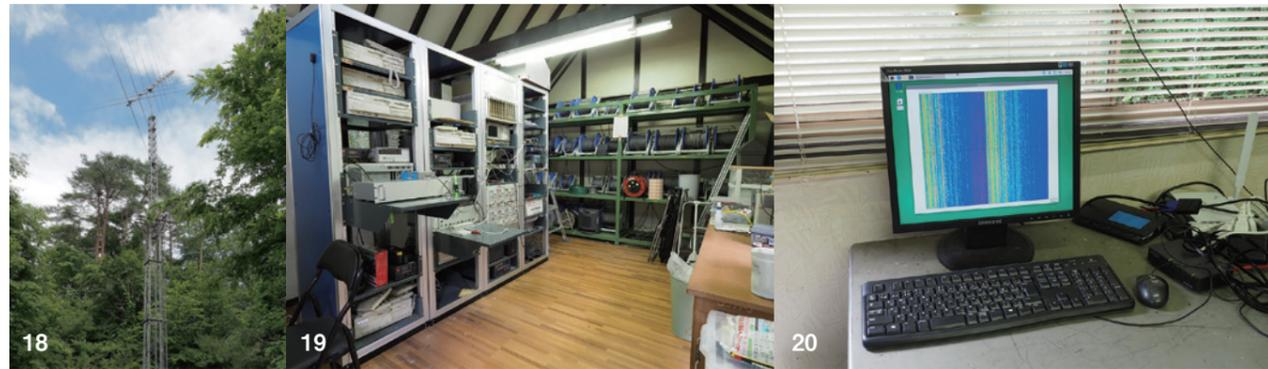
図18 木星・銀河デカメートル電波観測施設には、9基の短波帯（HF）アンテナが設置されているが、そのうちの6基のクロスログペリオディックアンテナで、木星からの電波の強度と偏波をモニタリングしている。観測波長は15~40 MHz。
