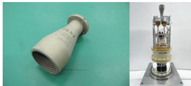
金属3Dプリンタで製作したコルゲートホーン（左）と、上部にコルゲートホーンを搭載したバンド1受信機（右）。
