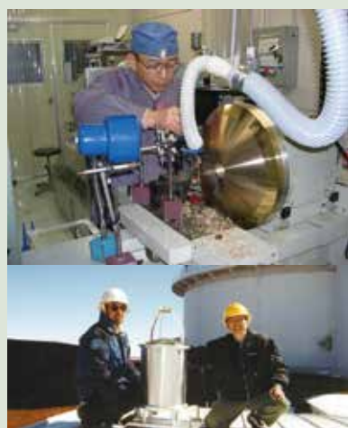
写真03 雲モニタの鏡面を加工中の筆者（上）とすばる制御棟屋上での設置の様子（下）。
