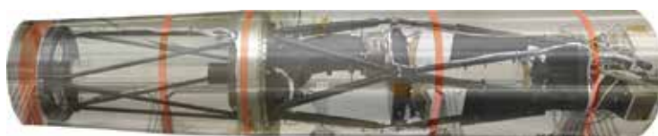
図03 CLASP2観測装置。画像合成によりロケットスキンを半透明化している。観測装置は全長2.5m、幅50 cm。[クレジット：国立天文台, NASA/MSFC, IAS]
