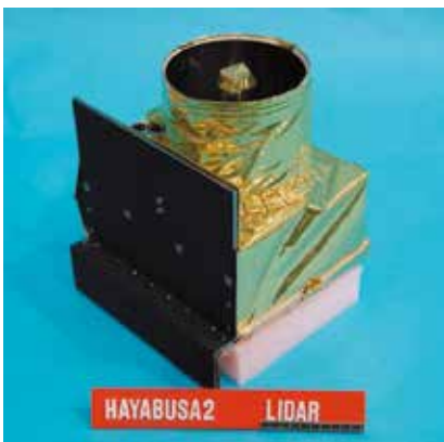
01 「はやぶさ2」レーザ高度計 (©JAXA)。大きさ241 mm × 228 mm × 229 mmで、重さは3.52 kgの小型軽量測距装置である。
