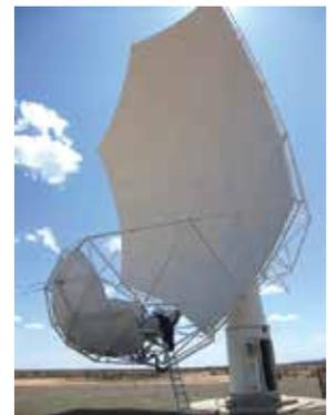
04 SKA1-LOWの試作アンテナ(左/credit:SKAO)とSKA1-MIDの試作アンテナ(右/筆者撮影)。MIDアンテナは梯子で簡単に副鏡と受信機にアクセスできる保守性の良さがある。
