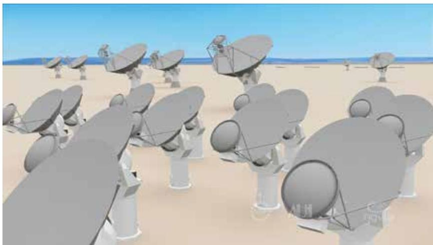
03 メインアレイとショートベースラインアレイの想像図。口径6mのアンテナと口径18mのアンテナで構成される予定です。(Credit: NRAO/AUI/NSF)
