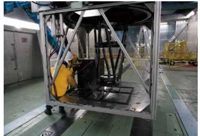
図06 すばる望遠鏡に搭載して調整中の光ファイバー位置計測用カメラシステム（MCS）。
