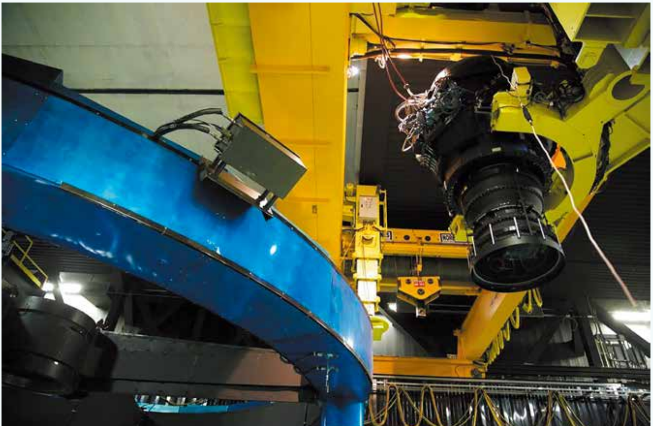
すばる望遠鏡（左）に取り付けられるHSC（右）。
