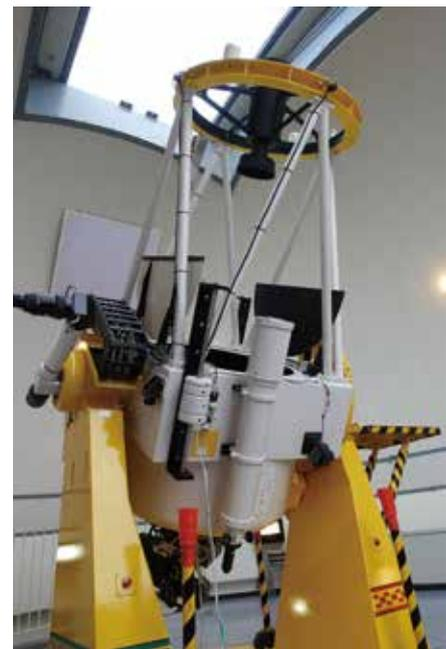
図05 石垣島天文台にある口径105 cmのむりかふし望遠鏡。筆者撮影。
