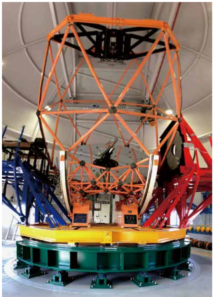
写真2 せいめい望遠鏡 固定台座（緑）、水平回転盤（黄色）、高度回転レール（白）、主鏡支持部を含む鏡筒（橙）、青ナスミス台（青）、赤ナスミス台（赤）と分割鏡主鏡、副鏡、第三鏡から成る。
