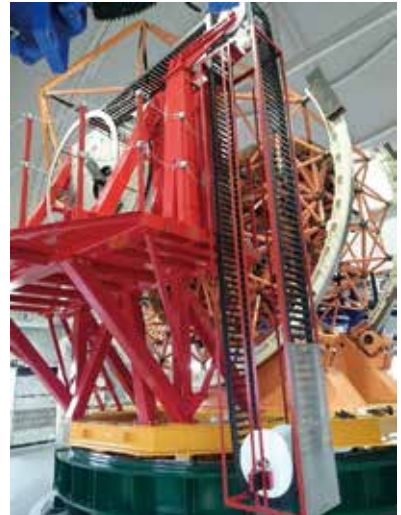
写真4 赤ナスミス台上の装置ローテータとケーブル巻き取り装置。
