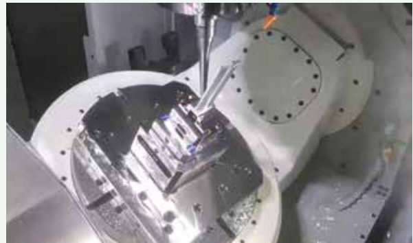
ブレード加工。5軸制御中。
