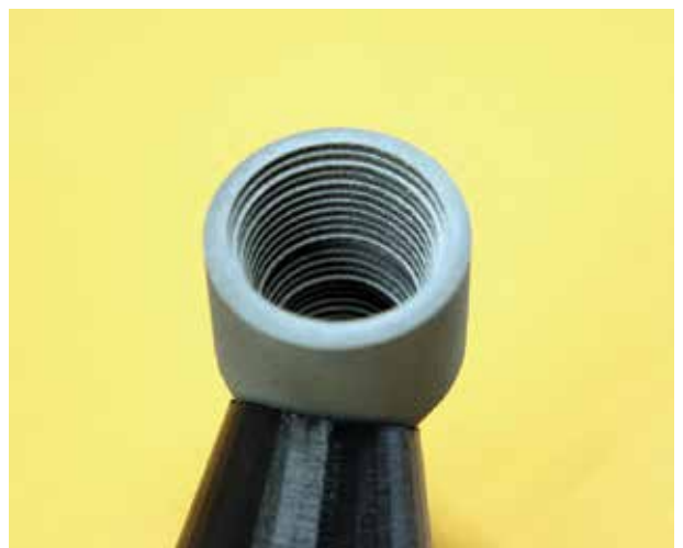
3Dプリンタで作成したバンド1受信機用コルゲートホーン。内部に凹凸が見えます。
