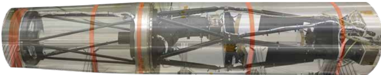
図02 CLASP2観測装置。画像合成によりロケット外筒を半透明化した。全長約2.5 m、全幅約50 cm。
