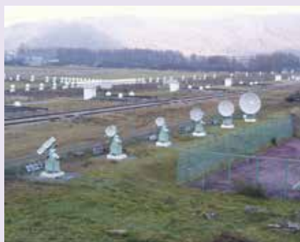
02 手前が強度偏波計群、後方が電波ヘリオグラフアンテナ群。
