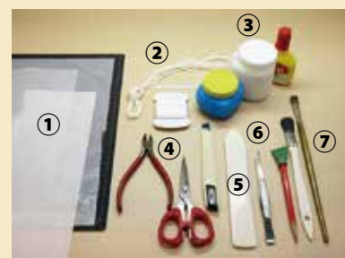
●修理につかう道具の一部。①和紙、クッキングシート②糸（麻、絹）、縫い針③糊、ボンド④ニッパー、はさみ、カッター⑤へら⑥ピンセット⑦刷毛、小筆
