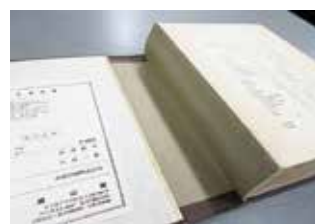
図04 ノドの割れ 厚手の資料に生じやすい。
