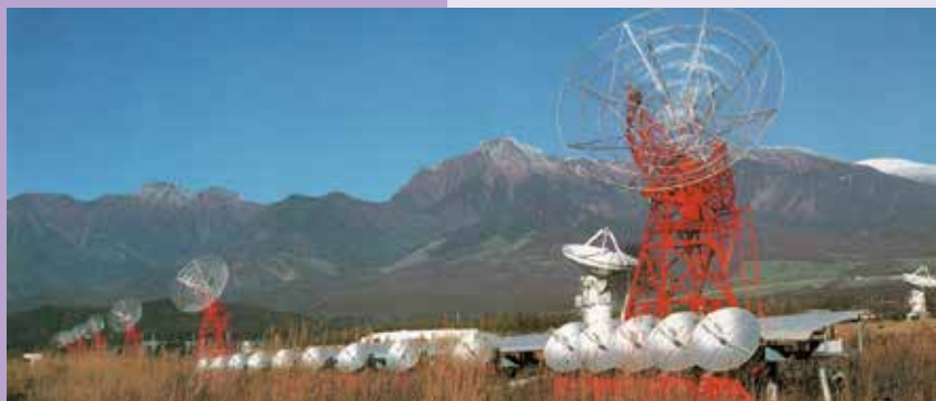
01 手前が17 GHz干渉計、後方のメッシュパラボラが160 MHz干渉計。背景は八ヶ岳。
