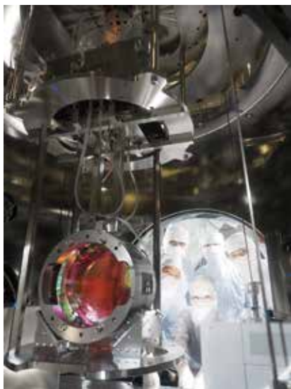
図06 PR2のインストールメンバーと鏡。赤くなっている部分が保護膜の塗られたPR2鏡になっています。
