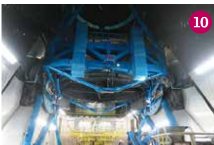
主鏡セルの取り外されたすばる望遠鏡。蒸着期間中に様々なメンテナンスも平行して行いました。
