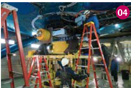
望遠鏡に取り付けられている周辺機器を専用の用具や台車等を使って取り外していきます。
