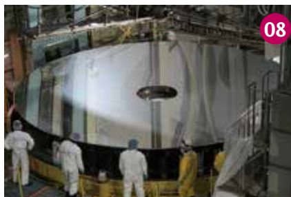
主鏡を蒸着下釜にのせて1次洗浄に備えます。全体的に白っぽく汚れています。
