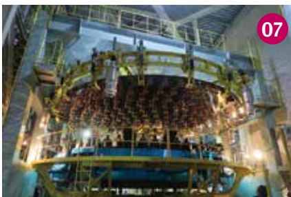
主鏡ハンドリング装置を使って主鏡を主鏡セルから取り外します。
