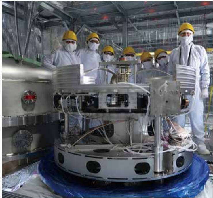
図07 BSのインストールメンバーとType-B倒立振り子。倒立振り子によってより低周波数帯での防振が可能となります。
