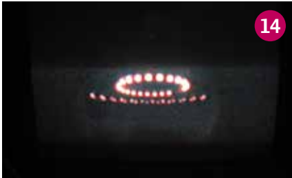
まさにアルミニウムが蒸発してコーティングが行われている瞬間の写真。
