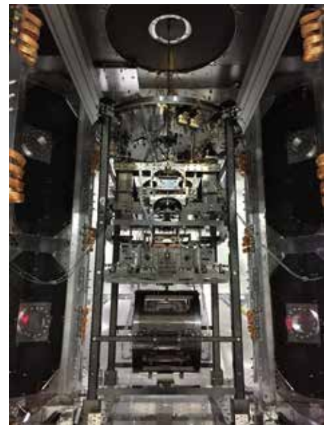
図08 低温に冷却されるType-A防振装置の最下部。
