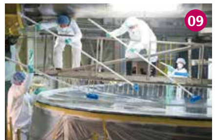
1次洗浄。まずブラシと洗剤で汚れを落とし、次に薬品で古いアルミコートを溶解除去します。
