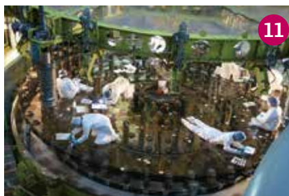
主鏡傷検査。主鏡の上に乗って目視で傷の確認を行います。この作業後、傷修復、2次洗浄を行いました。
