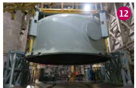
真空蒸着釜(の上半分)。この大きな真空容器を用いてアルミニウムを真空蒸着法で主鏡にコーティングします。
