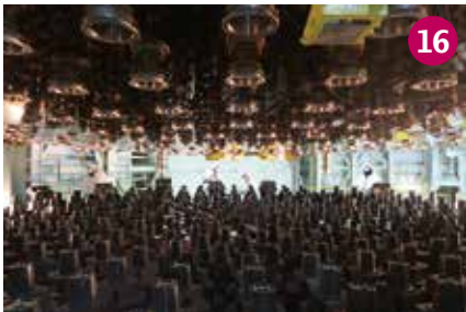
蒸着後は望遠鏡を元に戻していきます。主鏡を主鏡アキュエーターに慎重に搭載してきます。
