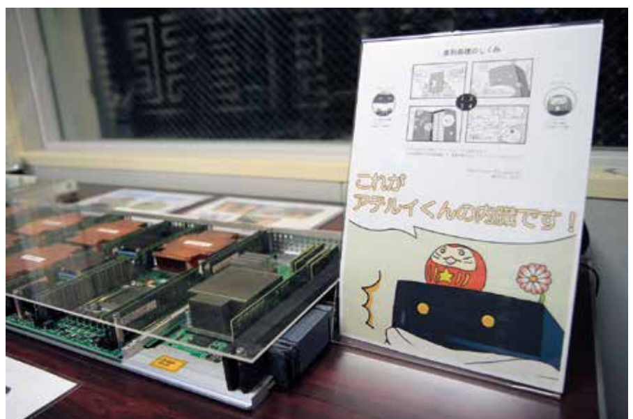
アテルイで実際に使われているブレード。1つのブレードには8個のCPUが搭載され、1つの筐体あたり48枚のブレードが差し込まれている、アテルイクンの「内臓」である。
