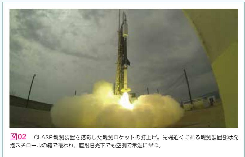
図02 CLASP観測装置を搭載した観測ロケットの打上げ。先端近くにある観測装置部は発泡スチロールの箱で覆われ、直射日光下でも空調で常温に保つ。
