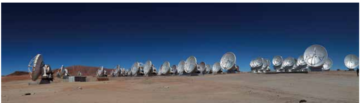
画像05 アルマ望遠鏡山頂施設に立ち並ぶアンテナ（2016年3月撮影）。一時的にメンテナンス中の1台を除く65台が標高5000 mに設置されていました。
