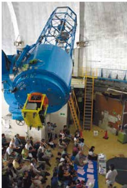
01 188 cm望遠鏡ドーム内、望遠鏡の真下で聴く講演会です。188 cm望遠鏡のカレグレン焦点に装着されているのはHIDES-FiberLinkの光取り込み部（オレンジ色の箱）です。望遠鏡で集めた光をここから光ファイバーで高分散分光器 HIDES (High Dispersion Echelle Spectrograph) に送ります。HIDESでたくさんの太陽系外惑星が発見されました。
