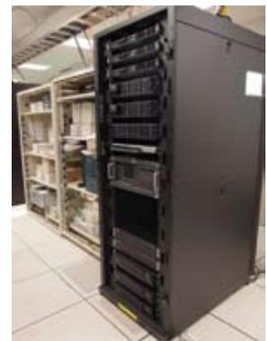
山頂に設置された制御系計算機群。CPUもハードディスクも並列に動作して、116枚のCCDを処理します。
