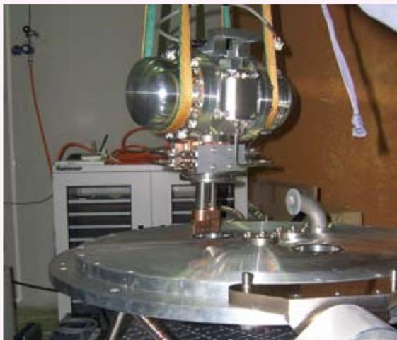
プロトタイプ CCD デュワーに取り付けられる冷凍機。
