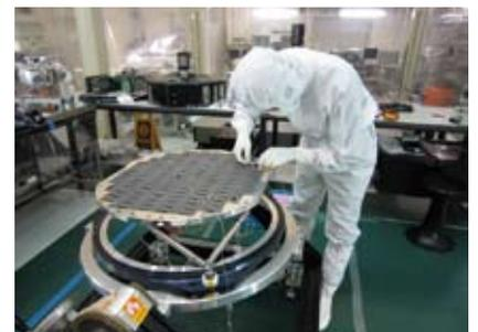
CCD 取付前の CCD 取付基板 (コールドプレート)。6 本の薄肉管トラス構造で断熱保持されている。写真奥には分解された冷凍機、CCD 読み出しエレキなども見られる。
