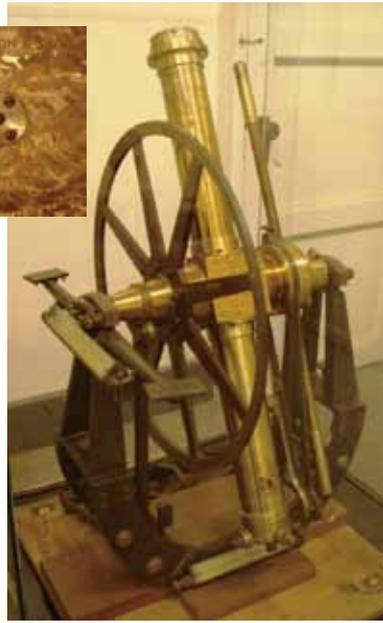
図3 24吋経緯儀の全体像。図4 国立天文台歴史館に展示されている復元された高度軸から上の部分。
