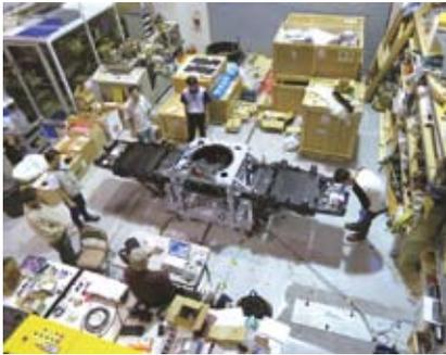
ハワイ観測所山麓施設で動作確認中の様子。展開した格納部の間に位置決め部が見える。
