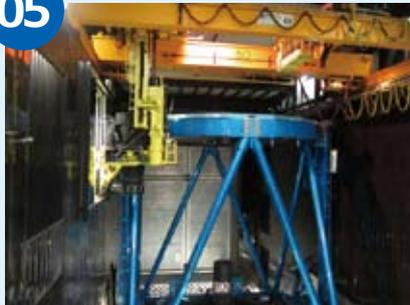
TUE階(左側壁の外側)からトップユニット交換装置(黄色のロボットアーム)へ受け渡されるHSC。この後、HSCは望遠鏡のトップリングを乗り越えて主焦点へと向かう。
