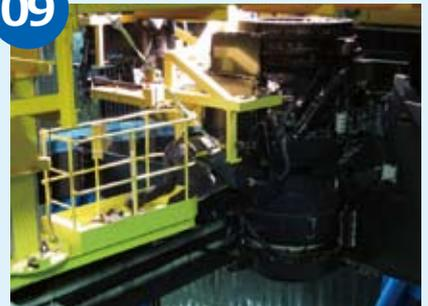
フィルター交換機構の取り付け。HSCへの固定やケーブル接続など、時にはトップユニット交換装置から身を乗り出しての作業が必要である。
