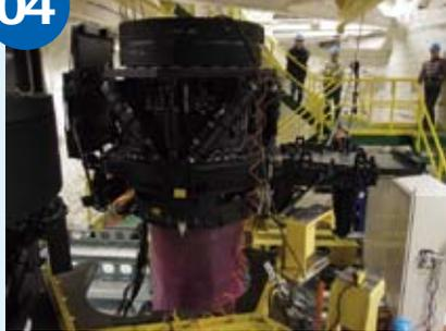
HSCに取り付けられたフィルター交換機構。フィルター交換機構は本来HSCが望遠鏡主焦点に搭載された後に取り付けられるが、望遠鏡搭載前にTUE階で動作試験を行った。
