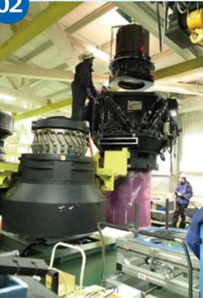
ドッキングを終えた補正光学系と主焦点ユニットはドーム4階TUE階へ運ばれ、他の副鏡とともにトップユニット選択装置(Unit Selector)に乗せられ待機している。ここでCCDカメラの取り付けが行われる。CCDカメラは一旦トップユニット選択装置の遙か上側まで引き上げられ、主焦点ユニットの中へ上から吊り込まれていく。TUE階待機時は補正光学系鏡筒がむき出しになってしまうため、赤いパルスシートで保護されている。
