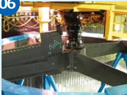
主焦点部に到着したHSC。主焦点部には副鏡や主焦点観測装置取り付け用の環状構造物(筒頂内環)があり、この中へ補正光学系鏡筒が挿入されていく。クリアランスは±15mmととてもシビアで、HSCの搭載は非常に緊張を要する作業である。
