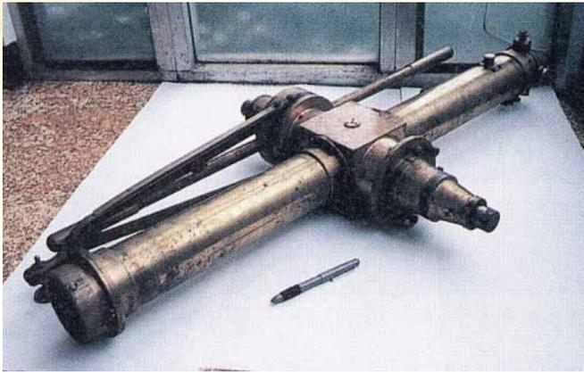
図1 発見時の24吋トロートン・シムス経緯儀望遠鏡の鏡筒部。
