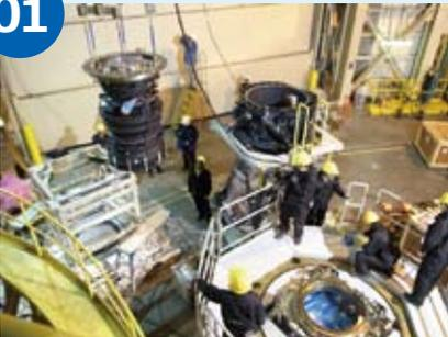
補正光学系と主焦点ユニットのドッキング。輸送用ジグから取り出された補正光学系(左上)は右下の精密調芯台へ乗せられる。その後、主焦点ユニット(中央上)が八角の台座ごと補正光学系の上にかぶせられる。精密調芯台で主焦点ユニットと補正光学系の精密な位置決めを行い、数ミクロンの精度でお互いを結合する。一つ一つの取り付けジグが大きく、主鏡蒸着を行うドーム1階エリアが組み立て作業で占有された。
