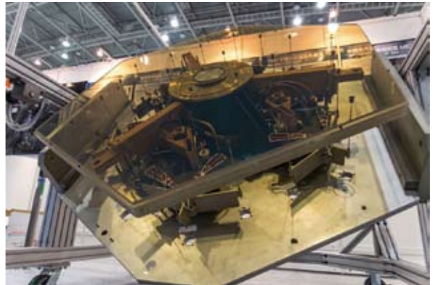
主鏡分割鏡の試作品。保持機構(アクチュエーター)付きのセグメントミラーで、このような分割鏡を492枚並べて、直径30mの1枚の鏡として機能させる。日本は鏡製作の一部を担当する(9ページ参照)。
