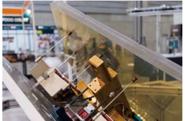
セグメントミラーの保持機構：複数枚並べた鏡面の位置をナノメートルオーダーで制御を行い、492枚が理想的な回駆双曲面になるようにする。
