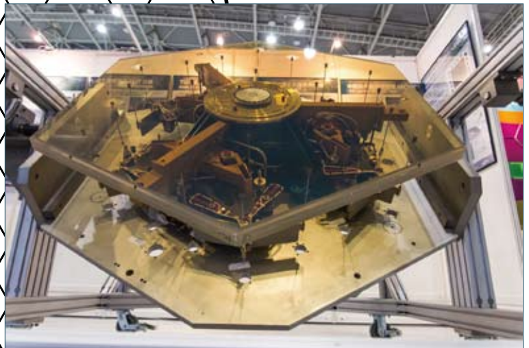
昨年度日本で試作された主鏡分割鏡。実際に表面加工が行われたもので、測定のために鏡の支持機構（これは米国で製作された試作品）に搭載されています。この表面に金属膜のコートが施され、反射率の高い鏡となります（14ページも参照）／撮影：長山省吾。
