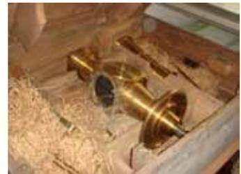
写真7 三鷹で見つかった1.5台目のプラン子午儀の望遠鏡部分
