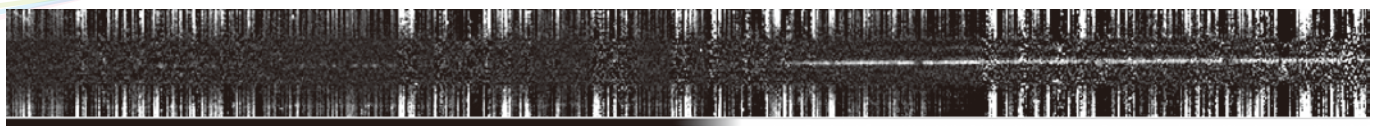
図2 FOCASによるGRB 050904残光の2次元スペクトル画像。横が波長で、より右側が長波長である。上下の縦筋は夜光輝線の引き残りによるもの。
