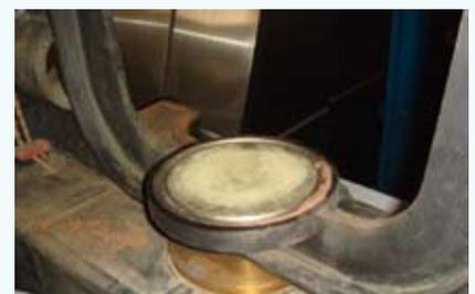
プランの子午儀の水銀盤：この水銀盤はプランの子午儀の東西の架台の中央に置かれている。90mmバンベルヒ子午儀にはこんな水銀盤はない。のみならず、このように子午儀の架台におかれた水銀盤は、この望遠鏡以外は知らない。
