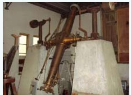
図4 ピアから外された状態だった望遠鏡をピアの所定の場所に復元した。
