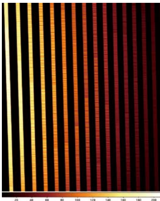
図2 HIDESによるヨードセルを通した連続光ランプ波長5500 Å付近のスペクトル画像。おびただしい数のヨウ素分子( I_2 )電子遷移振動回転吸収線が現れている。実際の観測では、これが星のスペクトルに焼き込まれる。
