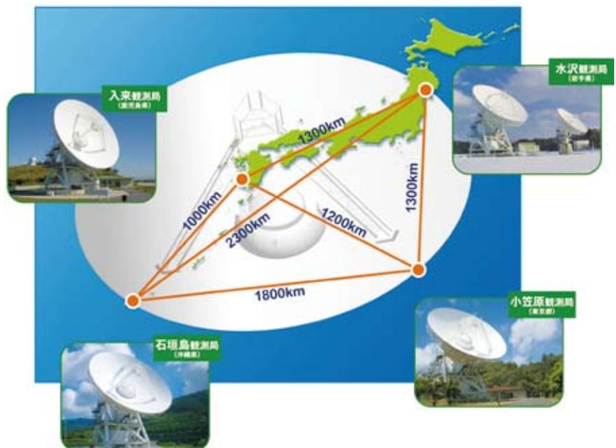
VERA4 局の配置と日本列島スケールの長大な基線長を持つ天文精測望遠鏡の概念図。
