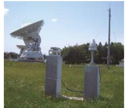
水沢局にて観測中のVERA水沢アンテナ、GPS、およびGalileo衛星受信アンテナ。
