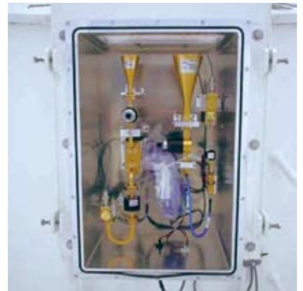
図3 VERAアンテナのフィードーム(図4参照)ベース上に設置された雑音電波源(雑音源ケースの蓋をあけたところ。普段はもちろん蓋を開けて内部は見えません)。このような雑音源をフィードームベース上に対称に4か所設置し、その位相をモニターすることで2ビーム間の遅延オフセットを補正します。
