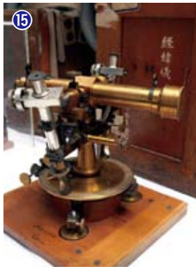
15 経緯儀（測地学委員会測地用経緯儀）：水平軸の目盛を読む顕微鏡が 2 本付いたハイグレード機。
