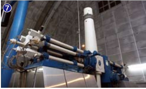
7 自動光電子午環：基本星表作成のために 1982 年に建設された天体の位置観測を行なう望遠鏡。
