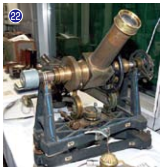
22 70mm バンベルヒ子午儀：可搬型の本格的な子午儀で、日本各地の経度決定の測量に使われた。
