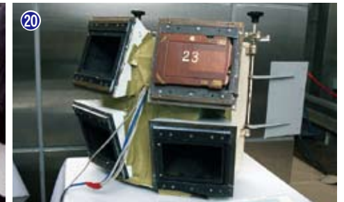
20 4連流星写真儀：レンズ前のセクターを回して流星の速度を測定し、広い視野をカバーした。
