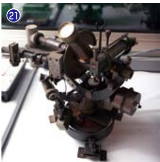
21 30mm バンベルヒ経緯儀：カール・バンベルヒ社製の 30mm 経緯儀。光電観測を試みた改造跡がある。
