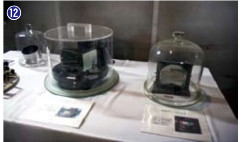
12 分光用大型プリズム（左）、反射グレーティング（右：太陽分光写真儀の分光室にあったもの）。
