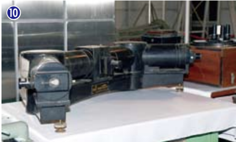
10 ダブルモノクロメーター：太陽分光写真儀の備品。精度得るために単色分光器を 2 段に使用。
