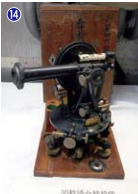
14 30秒読み経緯儀（測地学委員会測地用経緯儀）：明治時代のもの。経緯儀は測量に使用された。
