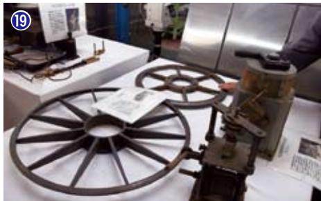
19 目盛環、赤道儀駆動用時計装置（ガバナー・右）：ガバナーは重錘で電気が不安定な時代に重宝した。
