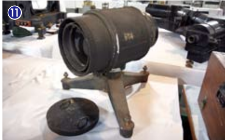
11 分光器カメラレンズ：太陽分光写真儀の半地下に設置された大型分光器のカメラレンズ。
