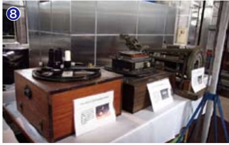
8 65cm 屈折望遠鏡用掩蔽観測接眼部（左）、同撮像カメラ（中・16 ページ参照）、同分光器（右）。
