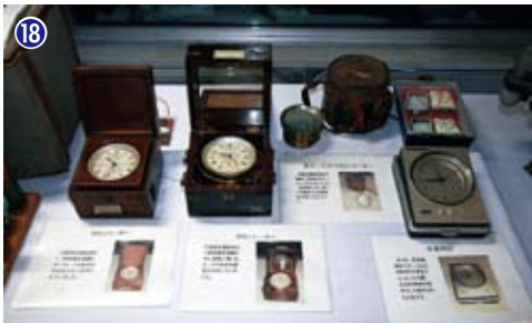
18 各種クロノメーター：クロノメーターは可搬用の精密時計で、測量地点の経度決定に使用。
