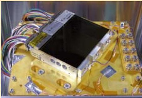
▲188cm 反射望遠鏡のクーデ室に設置された HIDES の全景。エッセル回折格子 (中央奥)、垂直分散平面回折格子 (左手前)、結像屈折光学系 (中央)、2k×4k CCD が3つ納まった CCD カメラ (右) がある。
