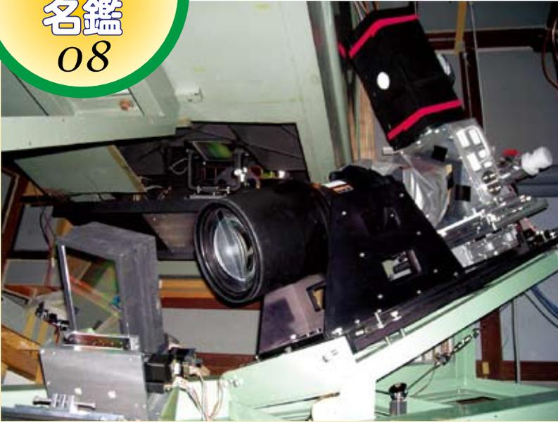
● HIDES (High Dispersion Echelle Spectrograph、ハイデス)は、エッセル回折格子と垂直分散平面回折格子を備えた可視域の高分散分光器で、188cm 望遠鏡クーデ焦点の断熱・空調された部屋にあります。二つの回折格子で分散を受けた天体の光は、球面レンズ5枚の屈折光学系により検出器上に先鋭なスペクトル像となって現れます。検出器には2k×4kの大型CCDを一つ搭載し、2000年から精度の高いスペクトルデータを提供し続けてきました。さらに2007年12月には検出器が、2k×4k CCD 3個のモザイク CCDへと進化しました。現在はファイバーフィード化による次なる進化に向け鋭意努力中です。
