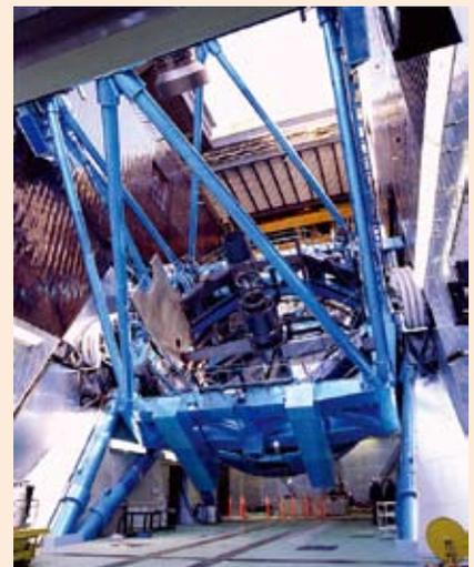
HDS はすばるの観測装置のなかでも最も安定した装置...なのですが、重くて普段動かすように作られていないというこの特性から、2006年10月にハワイ島で発生した地震では、唯一ダメージを受けた装置となってしまいました。精密な光学素子の配置にずれが生じてしまい、その修正作業には非常に苦労しました。現在は完全に復旧しており、着々と新たな観測成果を挙げています。
