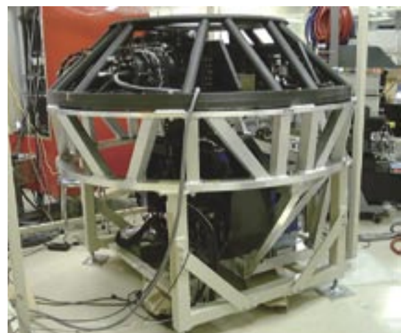
図2 すばる望遠鏡波面補償光学装置 AO。こちらも新型を開発中です。
