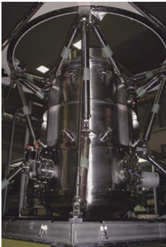
図1 すばる望遠鏡コロナグラフ撮像装置 CIAO (チャオ)。現在、より高性能の HiCIAO (ハイチャオ) を開発中です。
