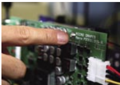
▲牧野さんが開発した MICRO-GRAPE の基盤。小久保さん用 GRAPE の心臓部だ。
