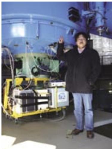
▲巨大な 188cm 望遠鏡のカセグレン焦点部に取り付けられた改良型の近赤外カメラ。「装置の開発も重視していて、今、大きなものを3種ほど、パレルで製作しています」(吉田さん)。
