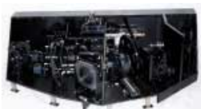
図1：Kyoto3DII。比較的小さな筐体（1.5m x 0.7m、約150kg）に光学素子、駆動系等を充填。望遠鏡からの光は奥側から筐体中央部に向かって入射。
