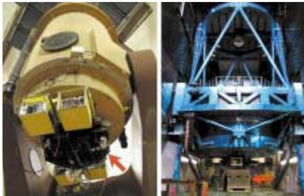
図3：マウナケア山頂のハワイ大学2.2m望遠鏡に搭載された黒い筐体のKyoto3DII(左)とすばる望遠鏡のカセグレン焦点に取り付けられた汎用コンテナ(右)。Kyoto3DIIはこの汎用コンテナ(銀色の箱)の中に組み込まれています。
