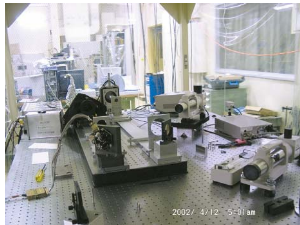
図3：望遠鏡を模擬した試験光学系
