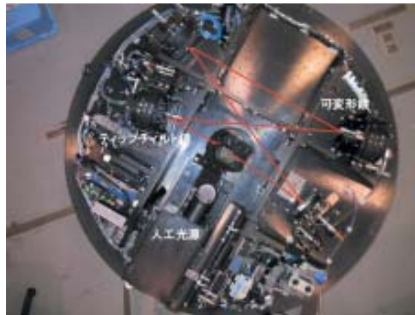
図2. すばる望遠鏡に取り付ける前の補償光学系を上から見たところ。望遠鏡からの光は、一旦平行光線になったのち可変形鏡で、補正を受け、再びティップティルト鏡で集光して、観測装置へと進む。
