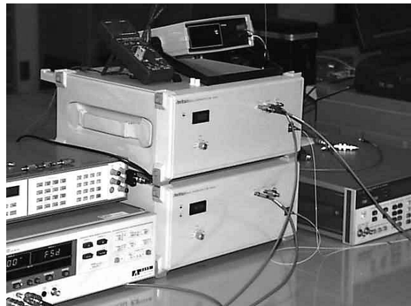
図2：能動型超高位相安定光ファイバー周波数信号伝送装置の外観図。右側が周波数信号伝送装置、左側が測定系
