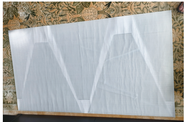
図3-06 量1枚くらいのポリカーボネート板から切り出したホーン本体用の台形板（2枚）および頭切り直角三角形板（4枚）。
