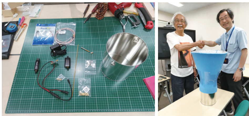
図2-01 （左）Amazonやホームセンターで調達したパーツ類。（右）ホーンアンテナ（缶テナ）完成の図。
