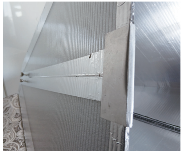
図3-10 ホーン本体部の左右の折り曲げ部分を補強する金具（奥に図3-09の固定金具の蝶ねじ（ナット）部分が見える）。
