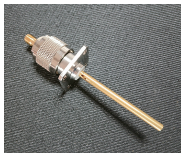
図3-03 真鍮パイプによるプローブとN型コネクタおよびN-SMA変換コネクタ。
