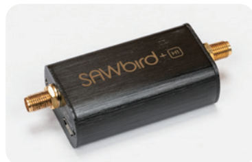
図1-05 21 cm線にチューニングされたLNAもNooelec社から発売されている。今回購入したのは、「SAWbird+H1」だ。
