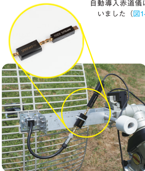
図1-06 銀河電波は微弱なので、アンテナ線にノイズが乗らないように、最短でLNAとSDRを接続し、アンテナの裏側に結束バンドで固定。PCまではUSB延長ケーブルを使用した。
