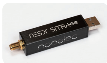
図1-04 SDRとしてバイアスTが供給可能なNooelec社製「NESDRSMarTee v2」をインターネット通販で購入した。
