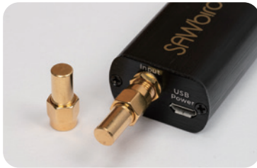
図1-08 SMAコネクタ 体型の50Ωターミネータを LNAに取り付けバックグラ ウンドを取得する。
