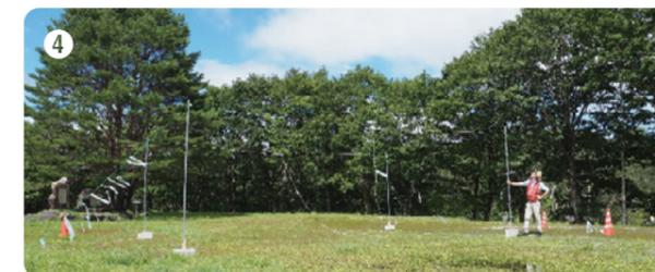
④完成したアンテナ。アンテナマストの間隔は、南北6.1m、東西約8m、張り綱を固定するベグの範囲まで定めると、設置には10m四方ほどの平坦な空き地が必要だ。もちろん、木星が見える環境でないといけない。
