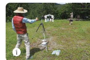
①デュアルダイポールアンテナは、2つのアンテナを南北に離れて平行に並べる。それほど厳密に設置する必要はないが、方位を計るのに方位磁石では真北を指さないで、南中時の太陽でできる垂線の影を基準にしてみた。
