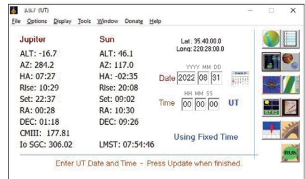
Radio-Jupiter pro3の起動画面。木星と太陽の位置情報と、さまざまな機能を持つウィンドウを開くためのアイコンが表示されている。観測地を設定（緯度経度、なぜか東経で入力しても西経表示される）すれば、時刻系は世界時（UT）とローカル（観測地が日本なら日本標準時）の切り替えが可能だ。また、現象をシミュレーションして時刻を設定することも、PCの内蔵時計でのリアルタイム運転もできる。
